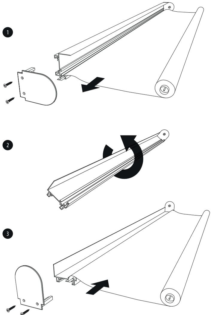
Zerlegen Sie zunächst das Rollo und kürzen Sie Oberschiene, Stoff, Welle und Beschwerungsstab auf die gewünschte Länge (Bild - Maß X). Fügen Sie das Rollo anschließend wieder vollständig zusammen. Achten Sie darauf, das die entnommenen Teile wieder an der selben Stelle plaziert werden.
