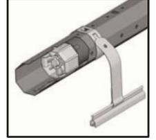
4. Kepenk motorunu kepenkle birlikte istenilen durma noktasına neredeyse ulaşılan kadar yukarı hareket ettirin. (motor daha önce kapanırsa madde 5 ile devam edin). Kepenk kapatma çubuğu dışarıdan görünür olmalıdır. Şimdi ayar pimiyile üst ayar piminde motor zamanında üst ayar noktasına ulaşana kadar çevirin. Şalteri tekrar yukarı yönüne getirin ve hassas ayarı yapın. Bunun için istenilen kapanma noktasına ulaşılan kadar artı yönünde çevirin.
