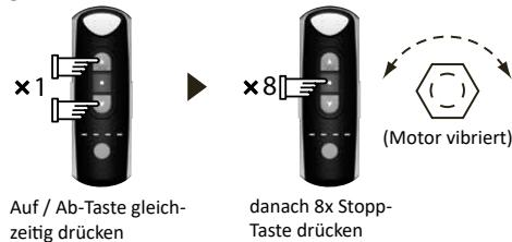
2. Drücken Sie nun innerhalb von 5 Sekunden die AUF- und AB-Taste gleichzeitig und danach kurz die STOPP-Taste auf dem neuen Sender, auf den Sie den Code kopieren möchten. Der Motor wird zur Bestätigung erneut kurz vibrieren. Der Code wurde nun auf den neuen Sender kopiert.
